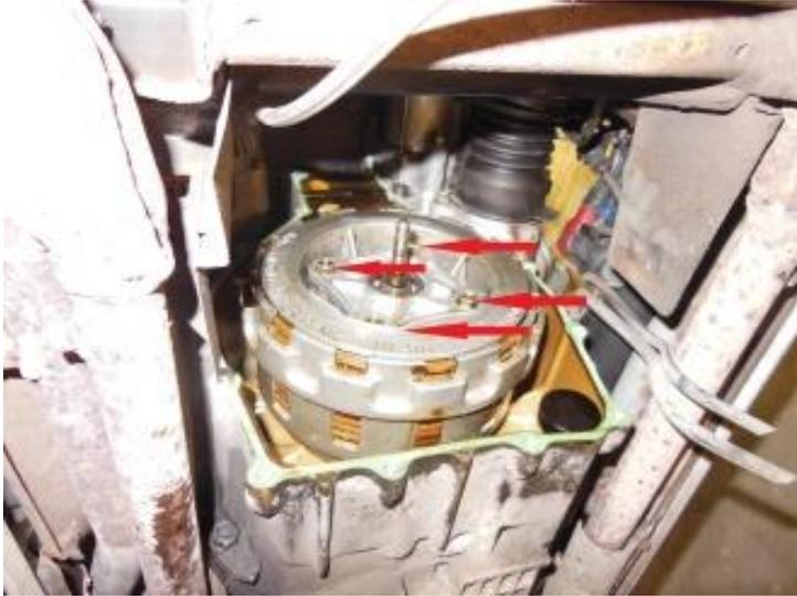
Jetzt ist die Zentramutter zu sehen, darunter ist ein Sicherungsblech. Die hochgebogene Lasche des Sicherungsblechs zurückbiegen und die Zentramutter lösen.
