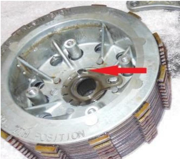
Mit einer passenden Nuss und eine Knarre mit vier – fünf Schlägen mit dem Handballen gegen die Drehmasse des Motors geht die Mutter ab. (hat bei mir so geklappt)
