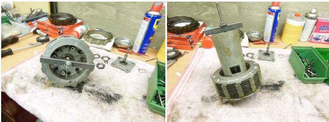
Mit der selbst gebauten Vorrichtung Feder spannen bis der Seegering lose ist.
