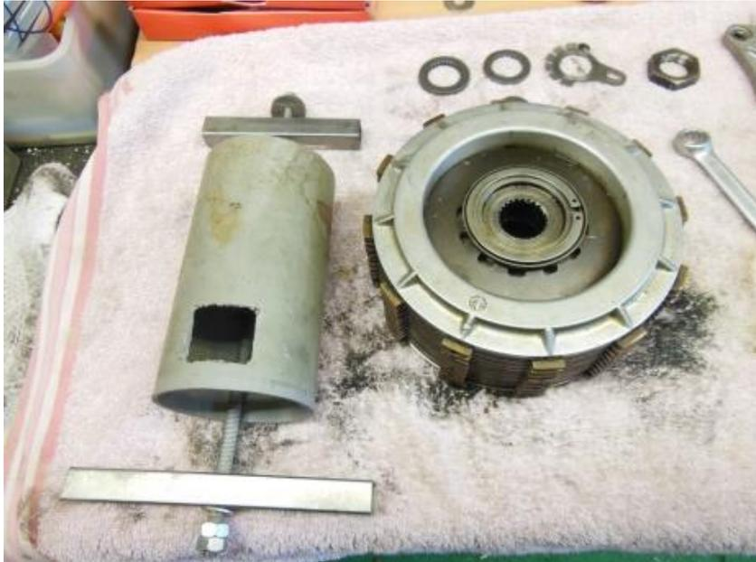
In die Mitte der Vierkanthrohre je ein Loch 8mm - 8,5mm bohren. An die eine Seite der Gewindestange zwei Muttern Kontern.
